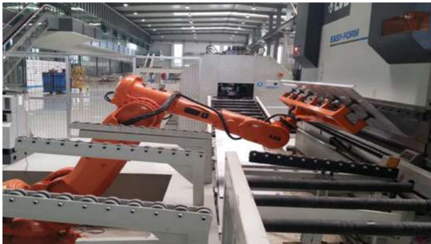
Отгиб автомата марки ABB Швейцарии Одну стенку за минуту
