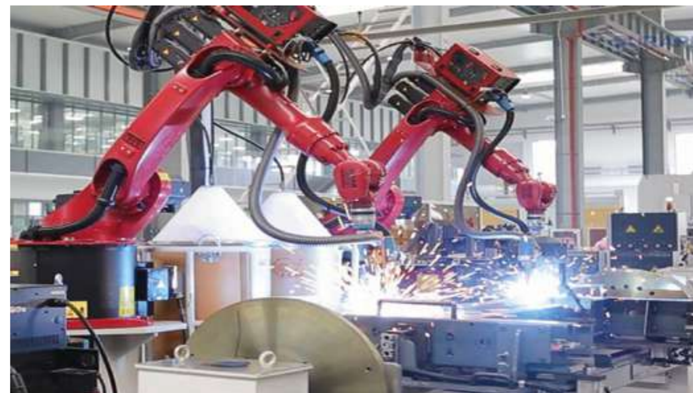
Сварочный робот немецкой марки KUKA Интегральная верхняя балка варится за 6 минут, а интегральная стойка – за 8 минут
