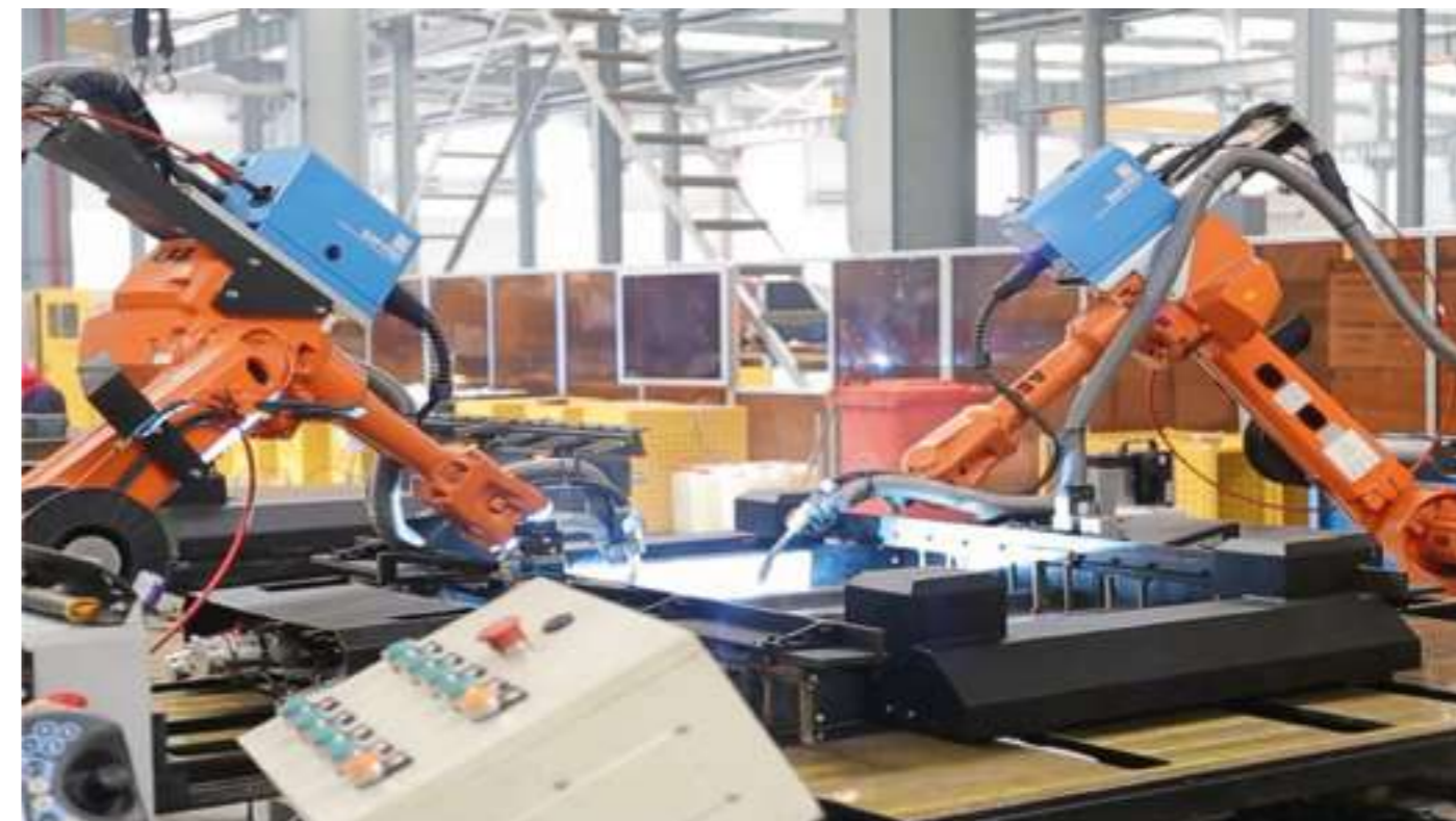
Сварочный автомат марки ABB Швейцарии Производительность – 10 000 шт. за одну смену
